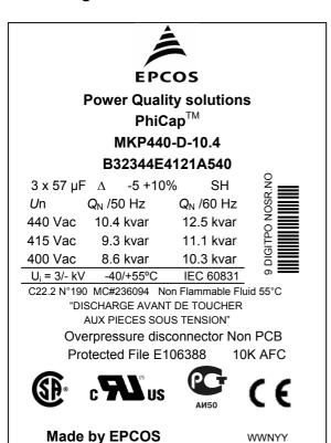
DISCHARGE CAPACITOR BEFORE HANDLING
